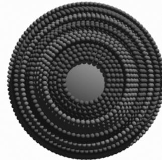
Abbildung 3: Illustration zum angenommenen „Schrottwolken-Szenario“ in den Modellrechnungen. Durch eine Rakete wird eine Nutzlast in die Bahn eines Satelliten gebracht und dort eine Trümmerschwad erzeugt, um den Satelliten durch Kollision zu zerstören (Skizze links). Die rechte Skizze illustriert den modellierten Aufbau (Teil) der Nutzlast, ein von kleinen Kugeln umgebener Kern aus Sprengstoff.
